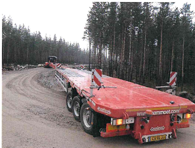
Vägar och passager kontrolleras för att säkerställa möjlig transport av kran och verksdelar. Bilden visar en så kallad "trial run" vid etablering i Målarberget, Norberg.
