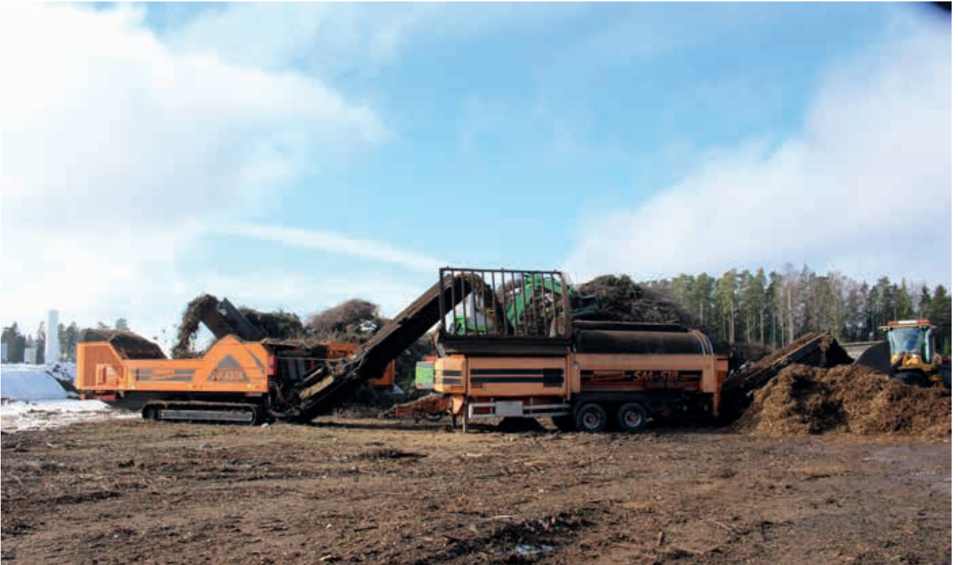
På samtliga våra anläggningar krossas returträ och grönsflis. En stor del av materialet går till Mälarenergis anläggning i Västerås där det blir till värme och el. Ett avtal har tecknats med Mälarenergi om bränsleleveranser för säsongen 2018/2019.
