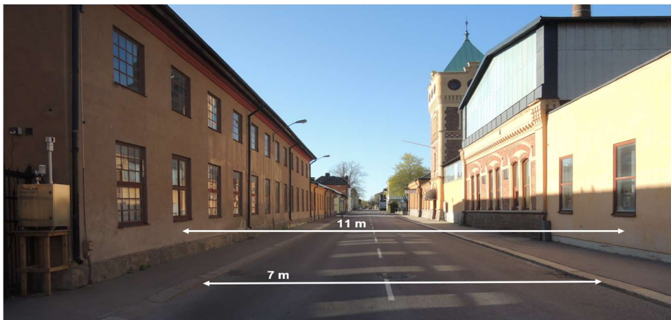
Fig. 3 Mätstationens placering på Glasgatan på kartan (vänster) samt gaturummets utseende i riktning mot NNV. Vägbanan är ca 7 m bred och gaturummet (avstånd mellan byggnader) 11 m. Byggnaden till vänster är ca 10 m hög, byggnaderna till höger mellan 6 och 12 m höga. Trafikvolym (ÅDT) 2500 fordon/dygn, 5.4% tungtrafikandel, skyltad hastighet 40 km/tim. Vägbanans beläggning är ABS 16 70/100.
